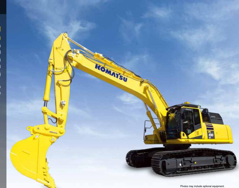
**NET HORSEPOWER** 268 kW/ 359 HP @ 1900 rpm **OPERATING WEIGHT**
